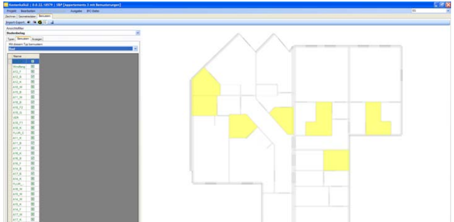
Bemustern der Bauteile, hier: Bodenbelag im Bad A12_B
